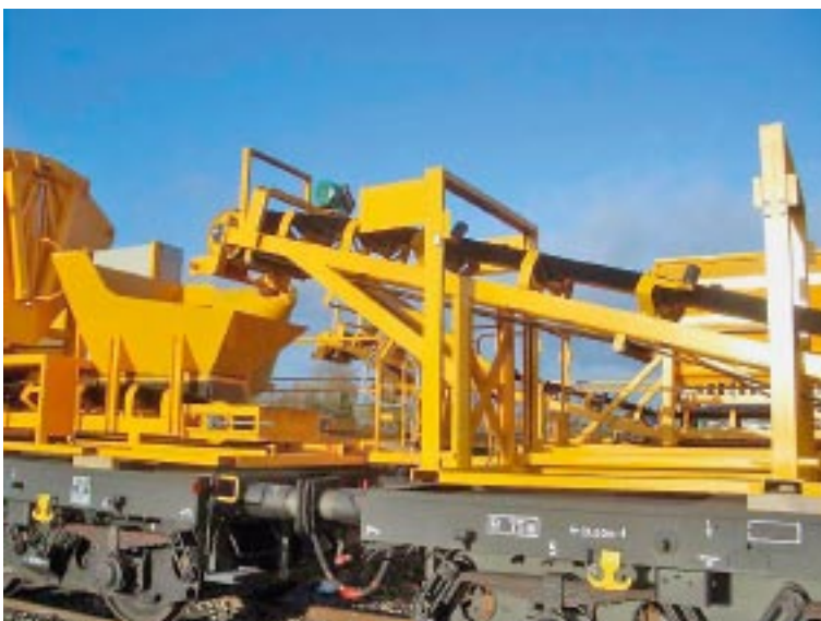
Bild 7: Übergabe zwischen zwei Wagen (Transportband und Trichter)
